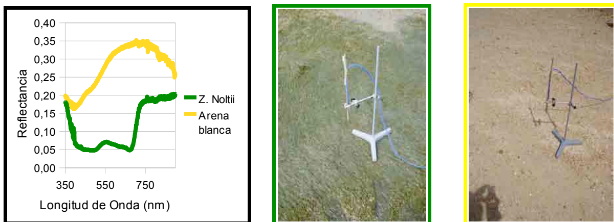
Figura 7: Espectros de campo utilizados en la corrección atmosférica.
