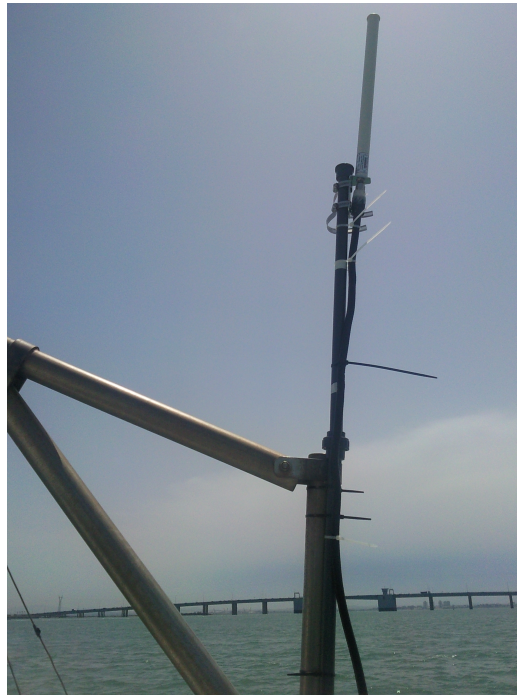
Figura 3.6: Detalle de la instalación de la antena en la embarcación Bryan Primero .
