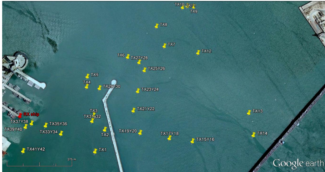
Figura 5.1: Ubicación fija del receptor (en rojo) y ubicaciones en las que se fondeó la boya transmisora (en amarillo) en la campaña de medidas de banda ancha.
