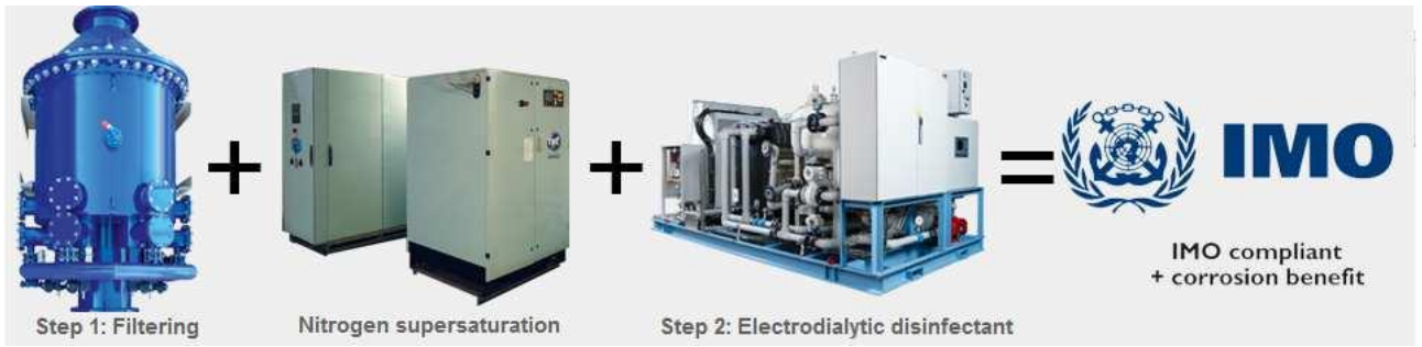
Figura 5.5 (Desinfección electrodiálítica Ocean Saber con sistema de nitrógeno)
