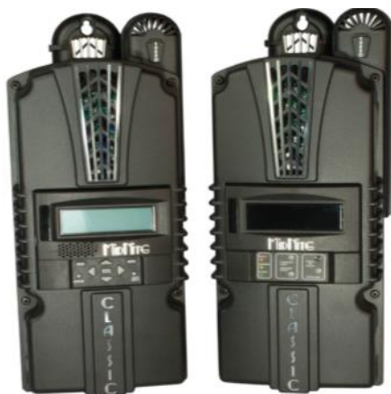
Ilustración 42 Regulador fotovoltaico midnitesolar classic lite 150
