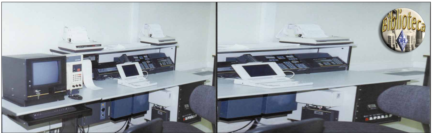
Consola de simulación del Sistema Mundial de Socorro y Seguridad Marítima.
