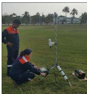
Fig. 2. Instalación de Estación Base Geometrics RBS G-862.
