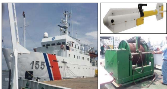
Fig. 3. Plataforma de investigación ARC Providencia, Magnetómetro marino Geometrics G-882, Winche de investigación geofísica de 2800 m a bordo del ARC Providencia.
