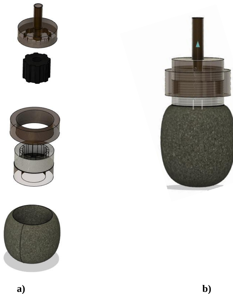
Figura 67. Modelo en 3D de las partes de la probeta para el sensor. Imagen a). De abajo a arriba: espuma antiviento, conector para la espuma, anillo fijador, soporte de TPU, cabezal para las conexiones. Imagen b) Conjunto ensamblado
