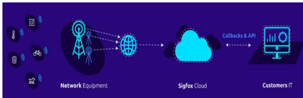
Figura 17. Principio de funcionamiento de la red SigFox
