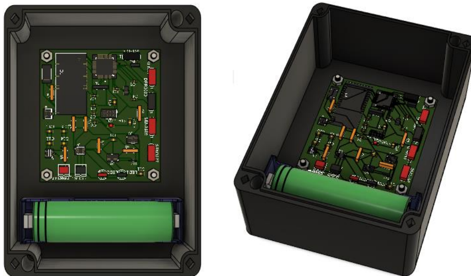
Figura 48. Posicionamiento PCB y batería dentro de la caja de protección
