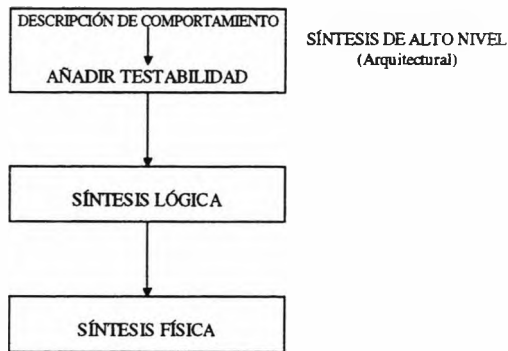
Figura III.23. La incorporación de recursos para facilitar el test se adelanta cada vez más en el ciclo de diseño.
