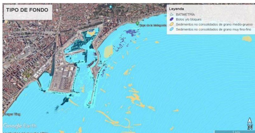
Ilustración 7. Plano de ecocartografía de fondo del puerto de Málaga.
