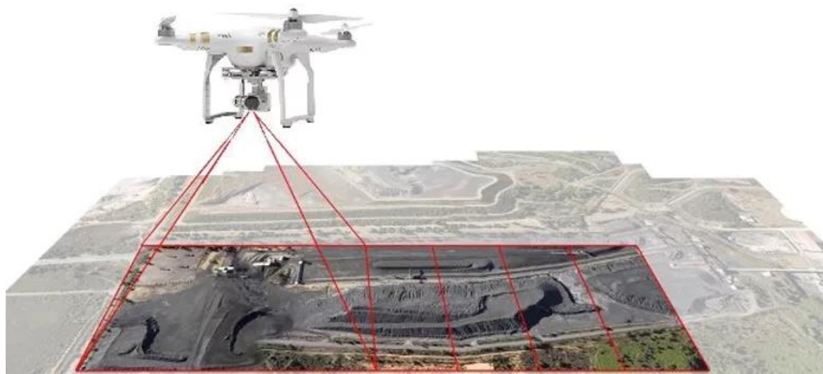
Figura 35. Ejemplo de toma de imágenes por fotogrametría aérea mediante dron. Se aprecia el solape entre las distintas capturas.
