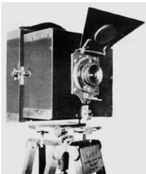
Figura 5. Primera cámara fotogramétrica de A. Meydenbauer de 1867 (Albertz, 2002: 19).
