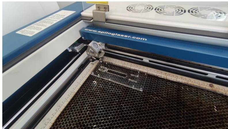
Ilustración 61: Resultado del proceso de mecanizado láser de la base del torno.
