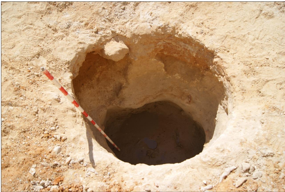
Figura 21: Filtraciones de agua bajo el estrato de arena blanquecina con nódulos de cal, tras la finalización de la excavación de P-58, que muestra el nivel piezométrico del momento de la intervención. (Fuente: Blanco Jiménez y Legupín Tubío, 2017)
