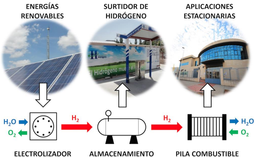
Figura 3.20: Elementos del sistema de hidrógeno
