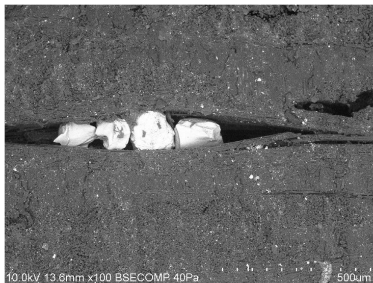
Figura 2.38. Partículas de abrasivo incrustadas entre las capas del material compuesto de matriz polimérica
