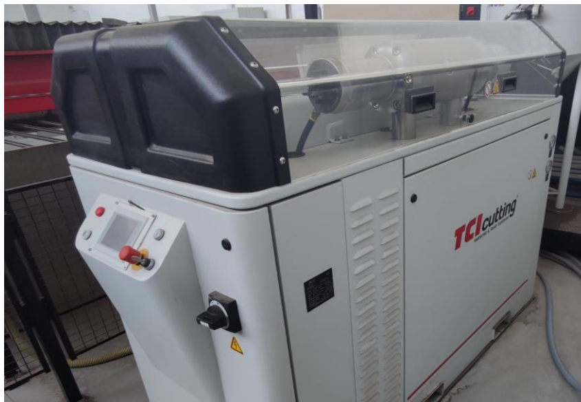
Figura 2.28. Sistema de presión lineal especializada en corte por chorro de agua de la marca KMT ubicado en la Escuela Superior de Ingeniería de la Universidad de Cádiz
