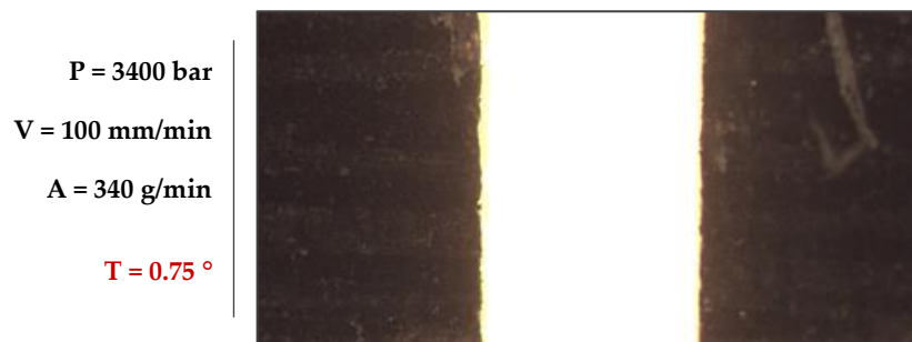
Figura 4.16. Combinación de parámetros que minimiza el defecto taper (P = 3400 bar; V = 100 mm/min; A = 340 g/min)
