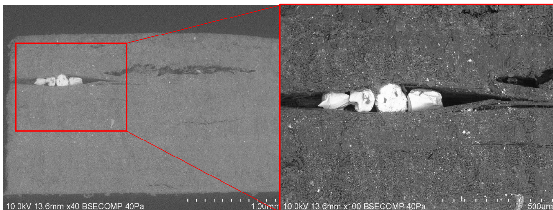
Figura 4.23. Partículas abrasivas entre las capas de CF RTP provocando una delaminación (x40 y x100)
