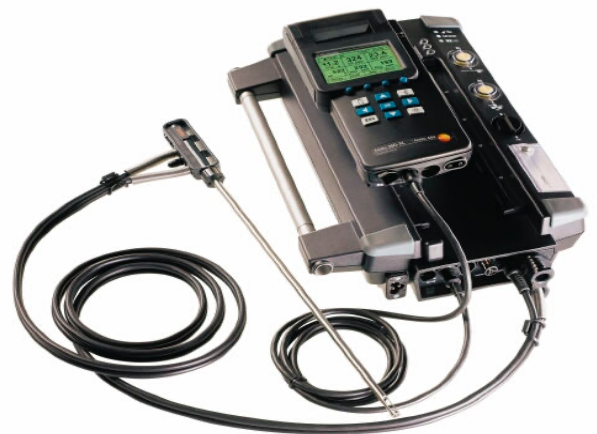
Figura 5. Equipo Testo 350 Maritime Fuente: Manual Testo 350 Maritime
