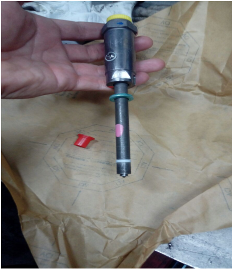
Figura 7. Inyector del motor de estudio Fuente: Elaboración propia
