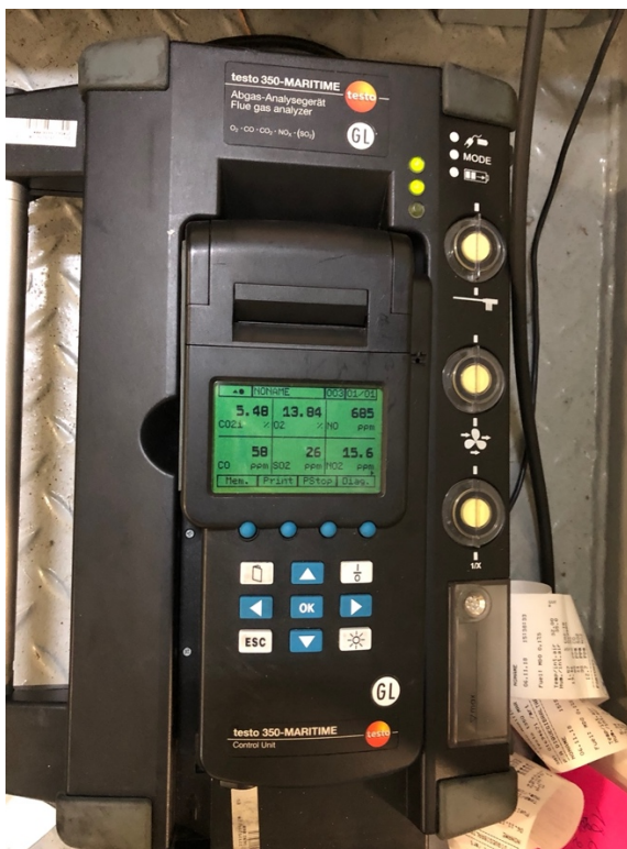
Figura 4. Equipo Testo 350 Maritime durante toma de datos Fuente: Elaboración propia
