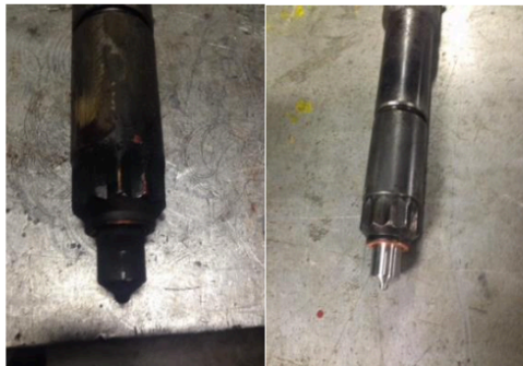
Inyector usado durante 5.000 h e inyector nuevo para reemplazo
