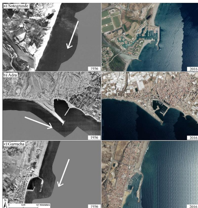
Figura 10. Ejemplos de sectores drift- y swash-aligned obtenidos de Molina et al. (II) en correspondencia de los puertos de Sotogrande (a), Adra (b) y Garrucha (c).
