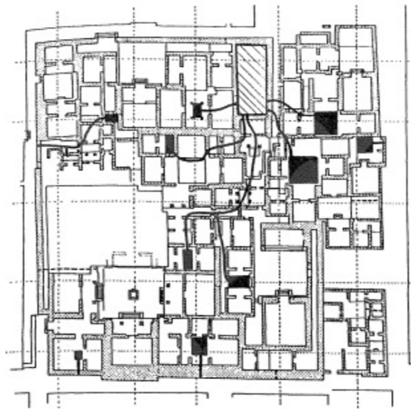
Figura 26. Red de desagüe y almacenamiento de aguas pluviales, nivel 3 del palacio de Tetitla.
