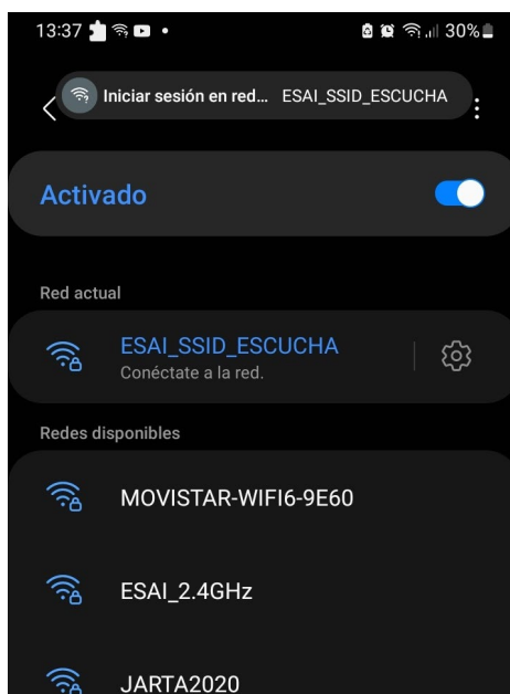
Figura 66. Conexión desde móvil android con el SoftAP generado por la ESAI. Creado por el autor.
