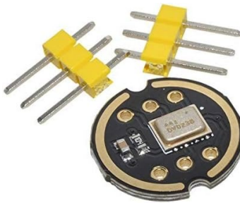
Figura 9. Vista de la capa inferior del módulo INMP441. Imagen extraída del producto en Amazon
