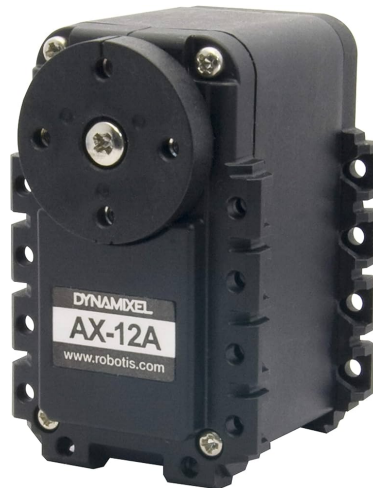
Figura 8.1: Actuador Dynamixel AX-12A. Imagen extraída de [194].
