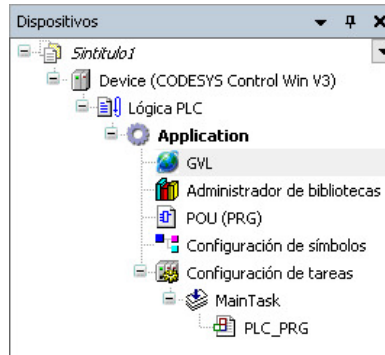
Figura 2.23: Área de trabajo. Fuente: Autor
