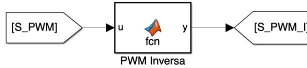
Figura 6.5.4: Generador de señales PWM. Diagrama de bloques en Simulink del sistema. Inversor de la señal PWM.
