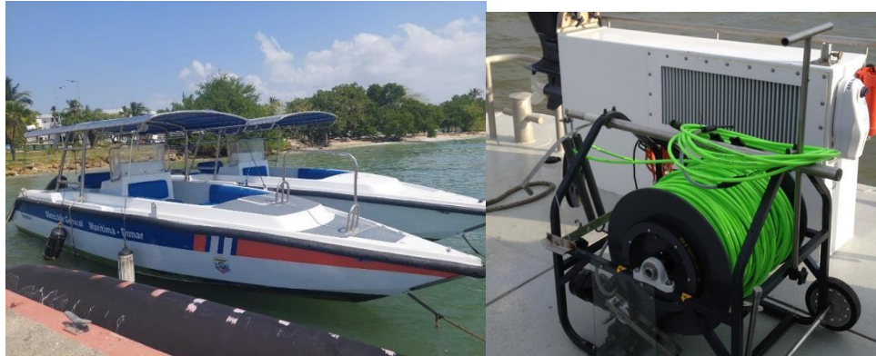
Figura 34. La lancha utilizada, tipo soundermax. Winche portátil de 300m
