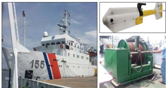
Fig. 3. Plataforma de investigación ARC Providencia, Magnetómetro marino Geometrics G-882, Winche de investigación geofísica de 2800 m a bordo del ARC Providencia.
