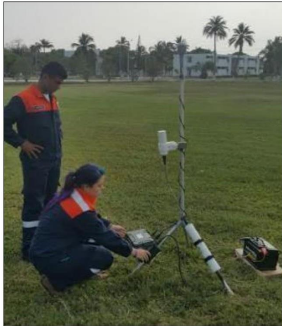
Figura 4. Instalación de la estación base RBS Geométrica G-862.
