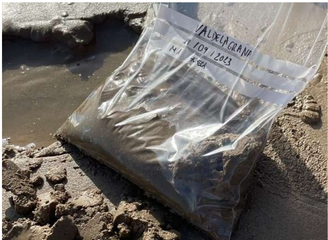
Figura 8. Bolsa de muestra con 800 gr de arena con un poco de exceso de agua. Para cada playa se recopilaron 10 bolsas de muestras como la de esta figura. Cada bolsa de muestra se dividió posteriormente en 5 submuestras: 130 gr para secar en mufla, 130 gr para secar a cada una de las potencias del microondas (700w, 595w, 462w, y 300w), y 150 gr extra por si ocurriese una posible pérdida.
