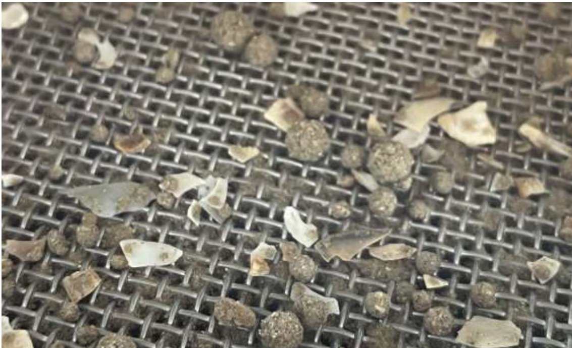
Figura 9. Ejemplo de un intento de tamizado de una muestra de arena que no está suficientemente seca. Las vibraciones de la máquina tamizadora crean esferas compactas con los granos de arena. También se puede apreciar visualmente cómo la humedad en la arena crea obstrucciones en los poros de la rejilla de cada tamiz.
