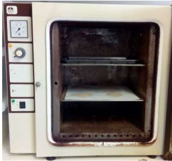
Figura 10. Mufla de laboratorio programada para secar a 110°C.
