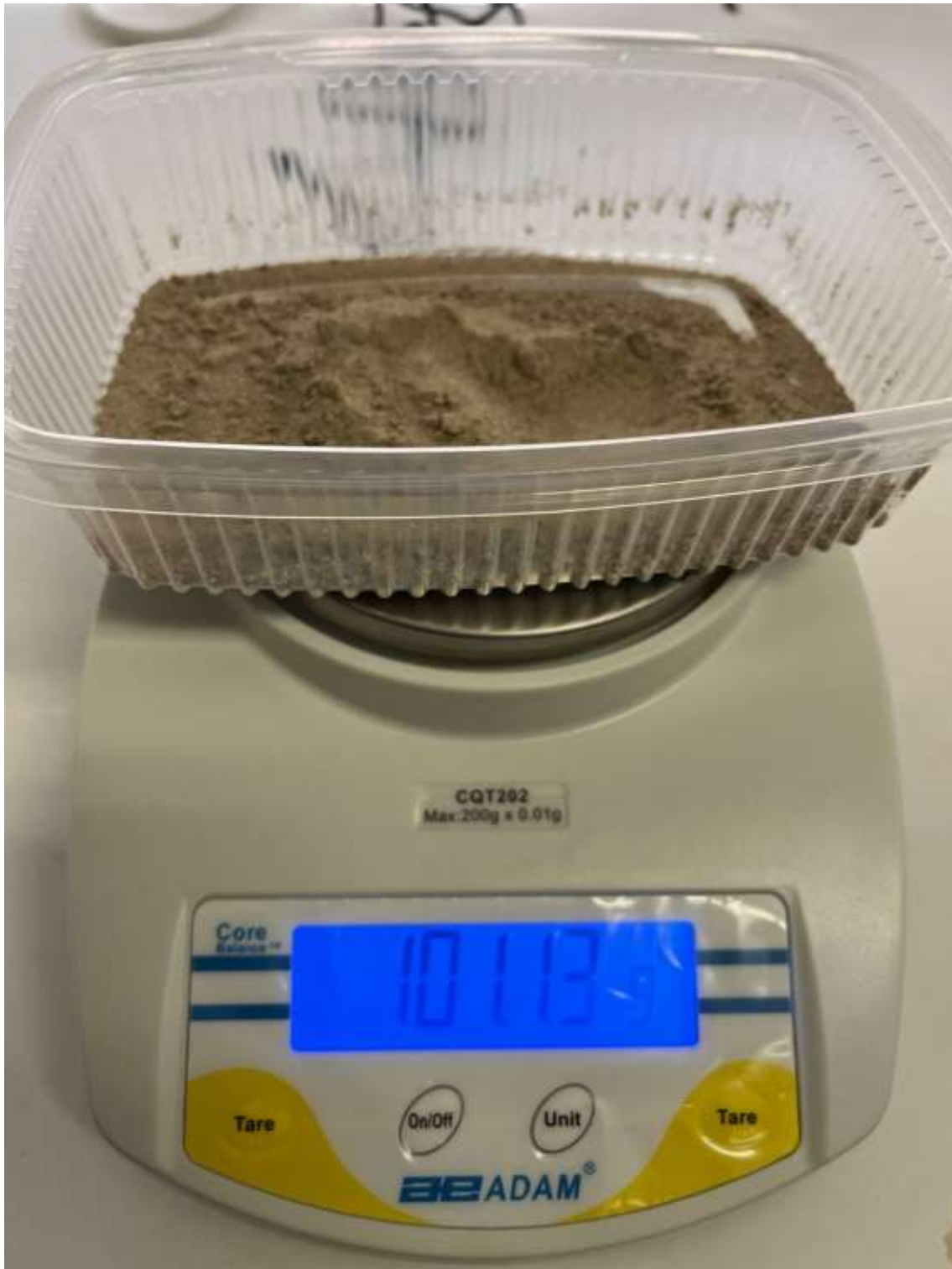
Figura 14. La misma muestra de arena de la Figura 13 pero ya completamente seca, pesando finalmente 100 gr.
