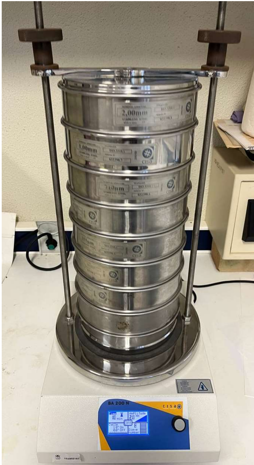
Figura 15. Máquina de tamizado con los 8 tamices, programada para tamizar durante 10 minutos y con una amplitud de vibración de 2 mm.
