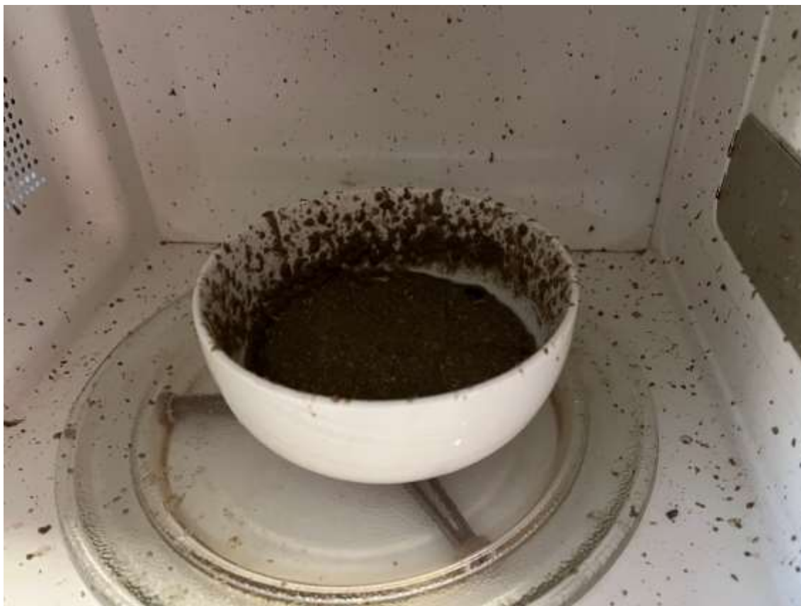
Figura 12. Vista del interior del microondas después de que una muestra de arena explotase durante el proceso de secado en microondas.
