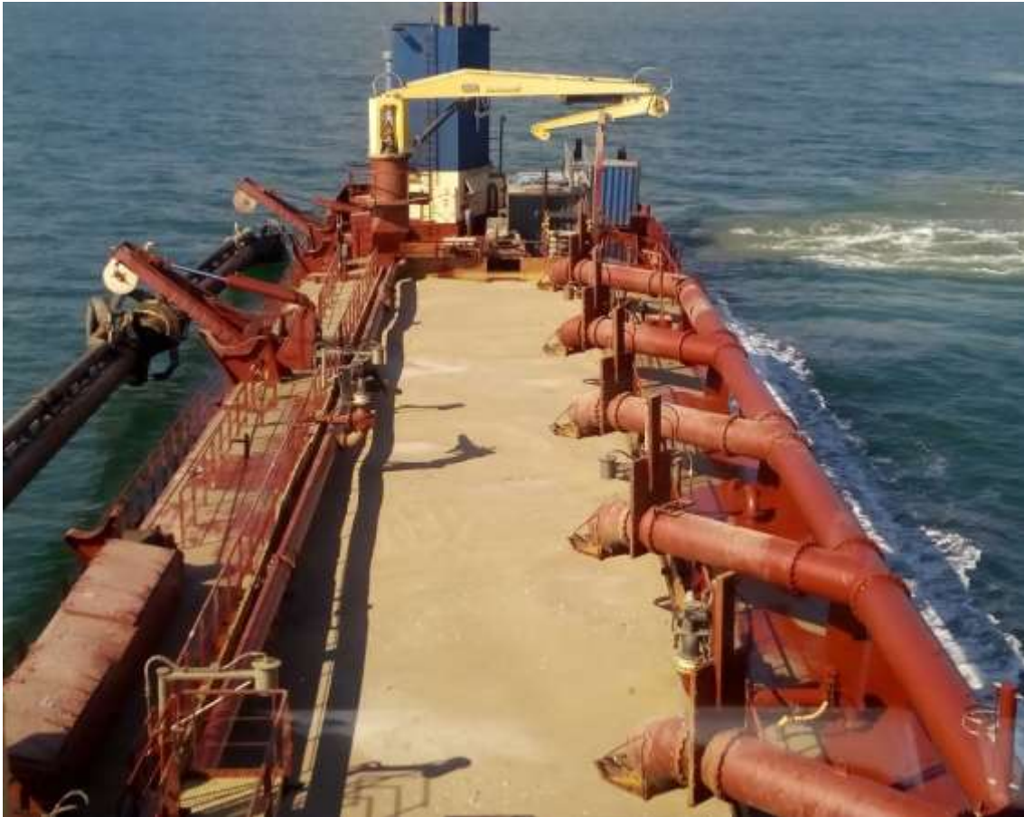
Figura 2. La cántara de la draga de succión en marcha, donde fueron tomadas las muestras de arena.
