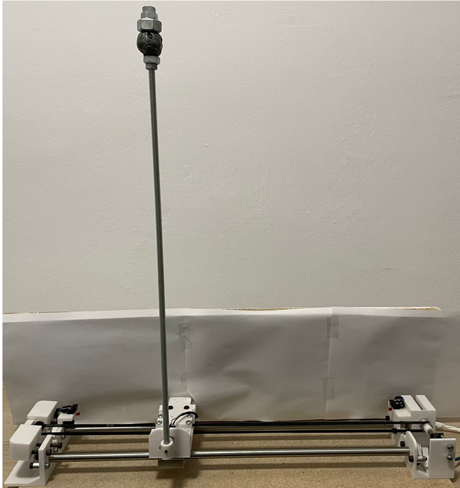
Figura 8.4: Imagen del sistema real construido con el péndulo en su posición vertical
