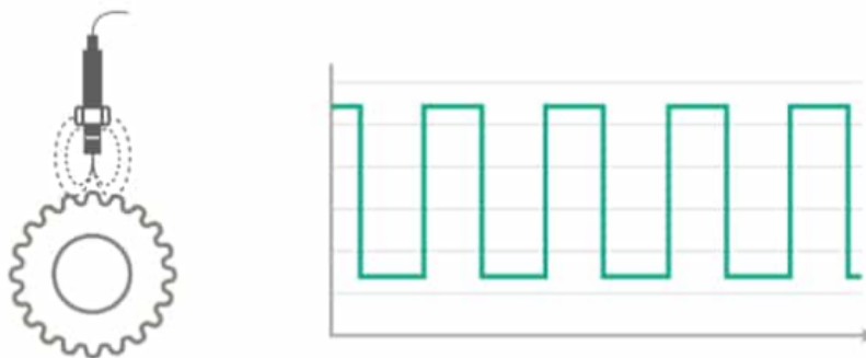
Figura 3.21: Funcionamiento de un tacómetro.
