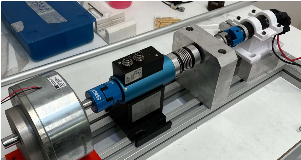
Figura 2.3: Banco de ensayo con motores DC de imanes permanentes [3].
