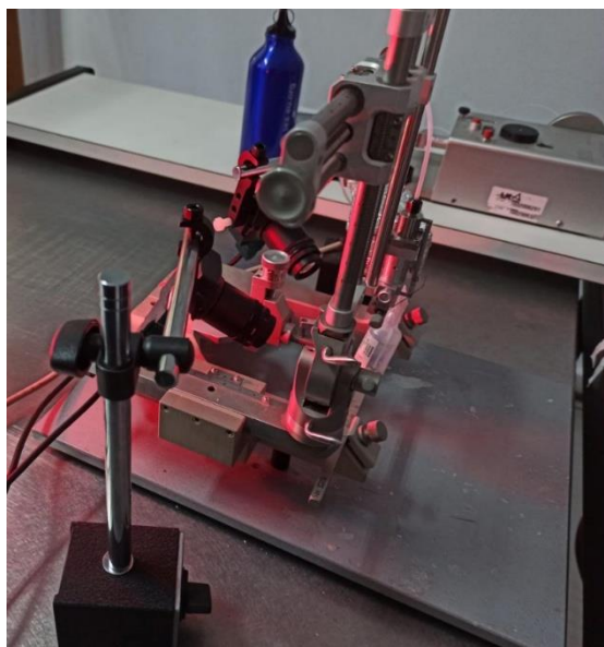
Figura 61. Montaje de sistema de pupilometría integrado al sistema de estereotaxia para el posicionamiento del electrodo de registro de las señales LFP en las coordenadas de cada LC.
