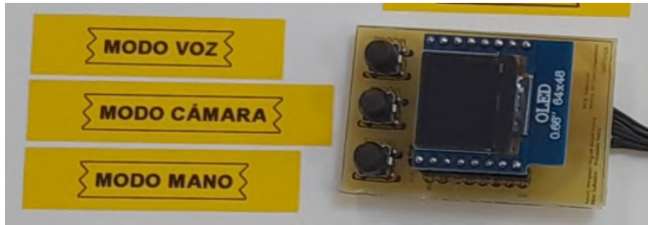
Figura 5.7: Interfaz disponible para el usuario de la prótesis. Contamos con 3 botones para cambiar de modo y una pantalla LCD que podrá ser usada en el futuro para visualización de datos o de manera lúdica.
