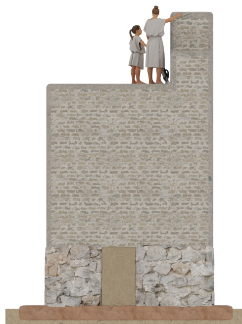
Figura 5. Reconstrucción virtual de la sección de la muralla del Cerro del Castillo en la que se aprecian los diferentes procesos de su construcción. © Autor.
